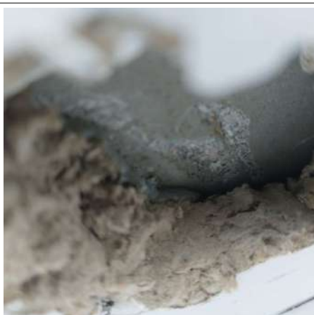
Prélèvement - P26 : R+4 / Bureau 41 - Plot de colle- (Présence d'amiante)
