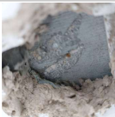
Prélèvement - P25 : R+4 / Bureau 41 - Enduit- (Présence d'amiante)
