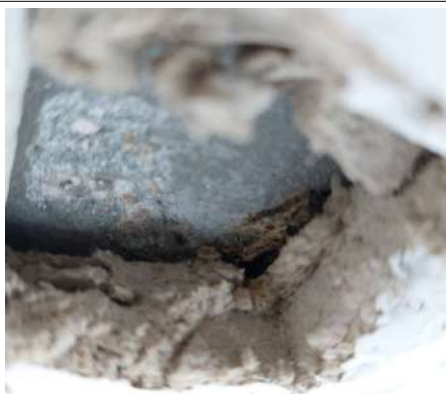
Prélèvement - P20 : R+4 / Bureau 48 à 49 - Plot de colle- (Absence d'amiante)
