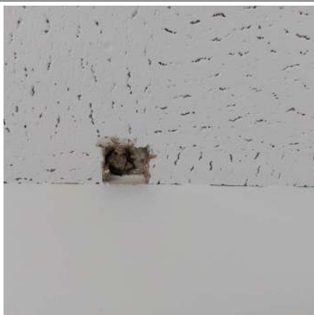
Prélèvement - P30 : R+3 / Box réception 1 - Enduit- (Absence d'amiante)
