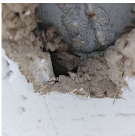
Prélèvement - P23 : R+4 / Bureau 410 - Plot de colle- (Présence d'amiante)
