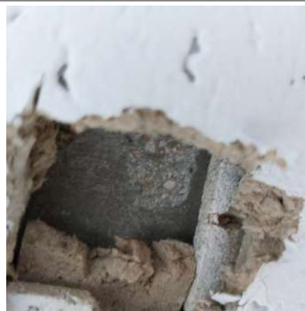
Prélèvement - P19 : R+4 / Bureau 48 à 49 - Enduit- (Absence d'amiante)
